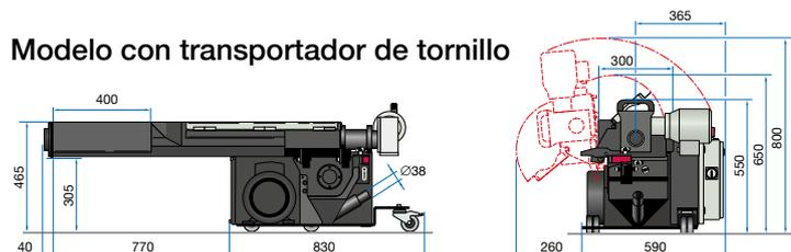
Apertura de la entrada del transportador de tornillo: 400 x 300 mm
